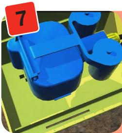
Cuando haya conectado la AQUAvalve a la tubería de 6mm, simplemente tire de la tubería hacia atrás para que todo el exceso de tubería dentro de la AQUAbox Straight salga hacia afuera. A medida que saque la tubería, baje la AQUAvalve para que se sitúe en la sección en T de la AQUAbox Straight.
