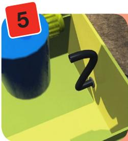
Tome la sección de 2 metros de tubería de 6mm y empújela (desde el exterior) a través del Top Hat Grommet de 6mm, como se muestra en la imagen. Tire de la tubería a través del Grommet de forma que queden 150mm aproximadamente dentro de la AQUAbox Straight.
