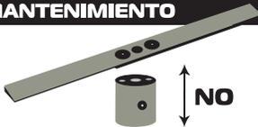
Para optimizar el corte, vaporizar el cuchillo con aceite vegetal y lavar frecuentemente el cuchillo y la rejilla con jabón o con alcohol isopropílico. Hacerlo cuando la máquina está parada. Afilar el cuchillo cuando se hace sentir la necesidad. Para afilar, nunca se retira el cuchillo de la estructura a la cual está fijado.
